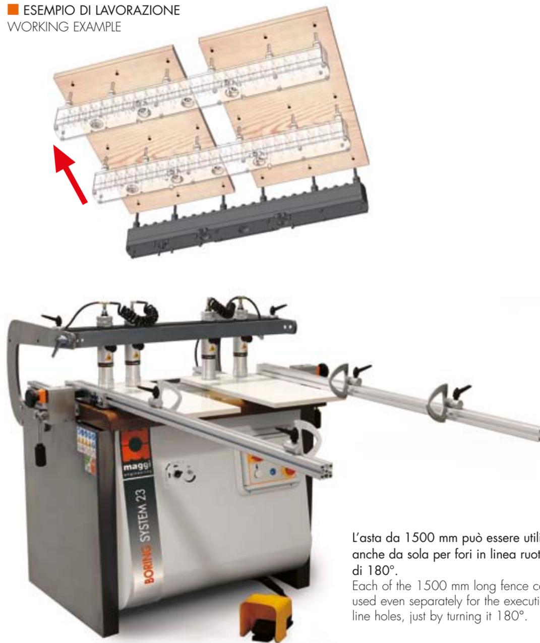
L'asta da 1500 mm può essere utilizzata anche da sola per fori in linea ruotandola di 180°.
